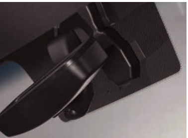
Predný kamerový modul s dažďovým senzorom a jednotkou pre automatické zapínanie diaľkových svetiel
