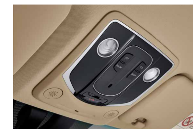
Ovládací panel nad hlavou vodiča a spolujazdca s dotykovým ovládaním vnútorného osvetlenia a strešného okna
