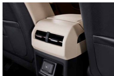
Výduchy vzduchu v zadnej časti stredového tunela
